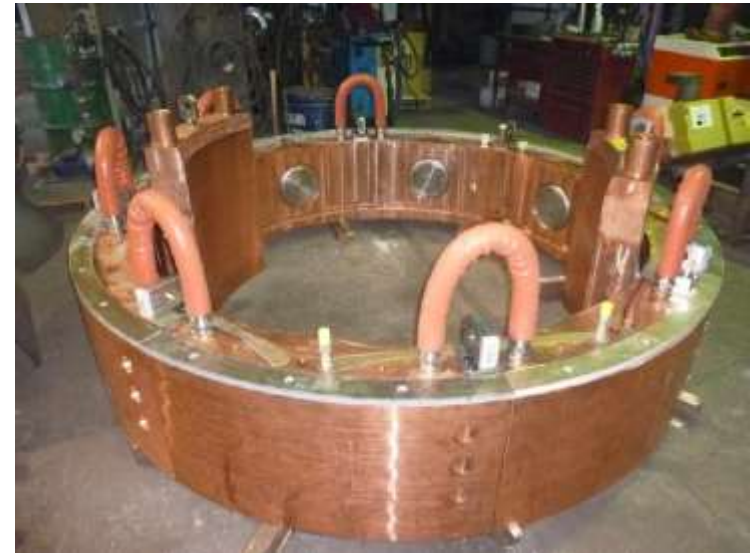
在法国和南非进行熔炉试装 - 电极底部组件
