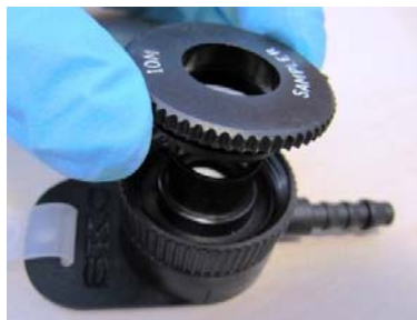
Figure 6 Loading of the IOM cassette in the IOM body
