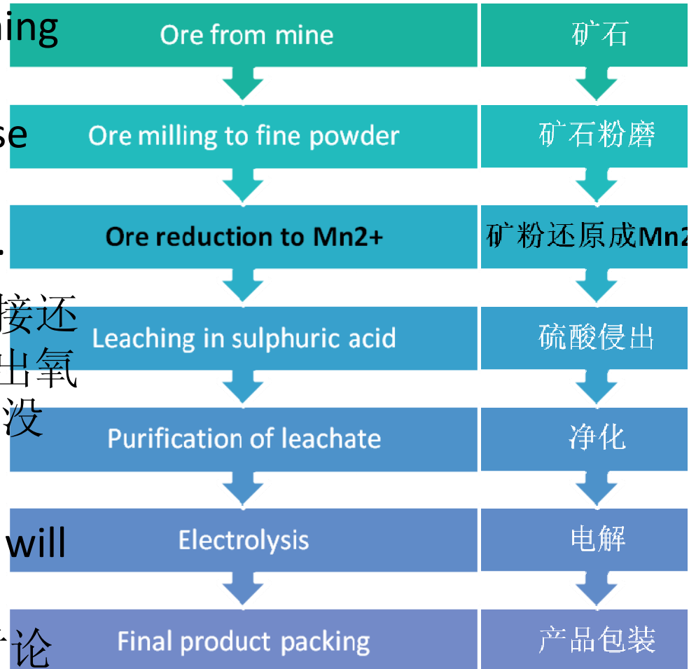
典型的电解锰或电解二氧化锰生产工艺流程
